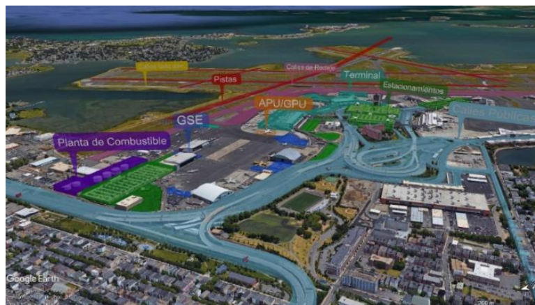
Figura 3. Principales fuentes de emisiones gaseosas contaminantes en un aeropuerto
