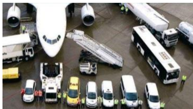
Figura 4. Vehículos de apoyo a las aeronaves (GSE)
