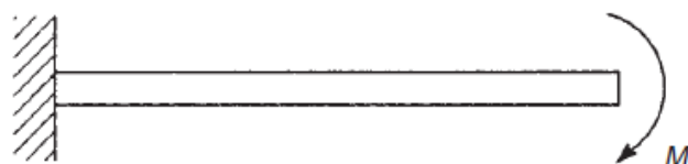
Figura 4. Componente estructural sometido a flexión pura
